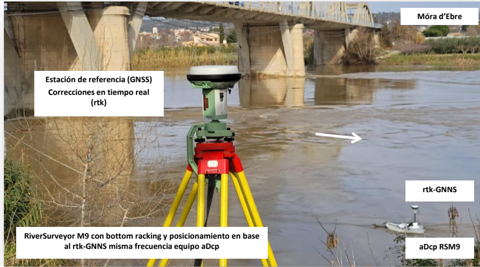
Figura 16. Equipo utilizado para la toma de datos: Sontek River Surveyor M9 (RS-M9) y Leica GNSS GS15. Autor: RIUS-UdL.
