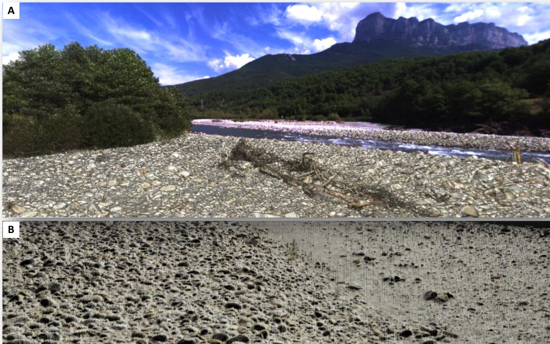
Figura 2. Heterogeneidad y estructura sedimentaria en el Río Cinca en Escalona. (A) Barra de sedimentos en la que se observa la heterogeneidad de los sedimentos (nube de puntos renderizada con el color de real de la imagen; datos obtenidos con un láser BLK360). (B) Parte del cauce en la que se observa una zona con cierto acorazamiento y una zona a una cota menor con presencia de sedimentos finos con algunos clústeres de sedimentos de mayor calibre (nube de puntos renderizada con el color de real de la imagen; datos obtenidos a partir de fotogrametría digital).
